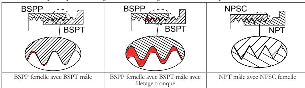
Note importante : La norme ISO 228, (Norme définissant les filetages **cylindriques** type BSPP) qui traite des assemblages où l'étanchéité n'est pas faite dans le filet a défini un filetage male tronqué ne comportant pas de tête de filet arrondie. De nombreux constructeurs utilisent à tort cette forme de filet pour réaliser des filetages mâles **coniques**. Cette forme de tête de filet tronquée provoque une fuite en spirale
