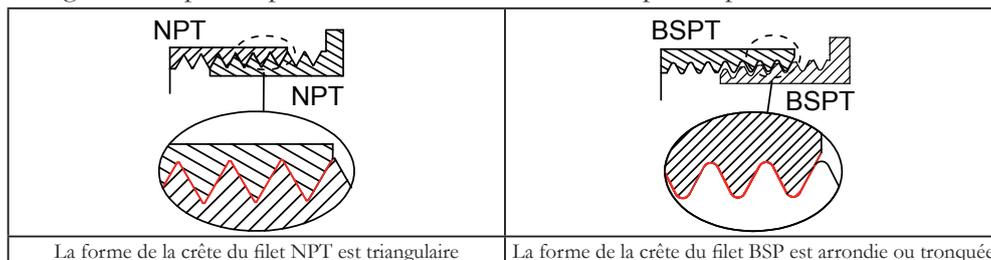
Dans les deux types de filetages (BSP et NPT), la conicité est de 1/16, soit 6.25% (A l'origine, ce rapport 1/16 correspondait au rapport entre 3/4 de pouce et un pied). En raison de cette conicité, un filetage mâle conique ne peut se visser que d'une certaine longueur sur un filetage cylindrique avant de bloquer.
